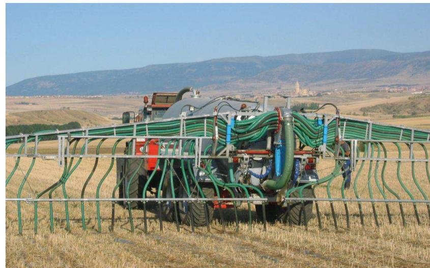
**Figura 11. Esempio di spandiliquame a banda con distributore rotativo per migliorare la distribuzione laterale (trailing hose)\***
